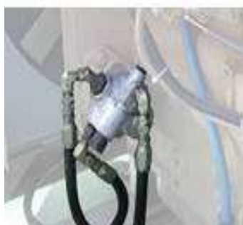
Pompe RPA montée sur un dispositif d'entraînement auxiliaire du moteur
